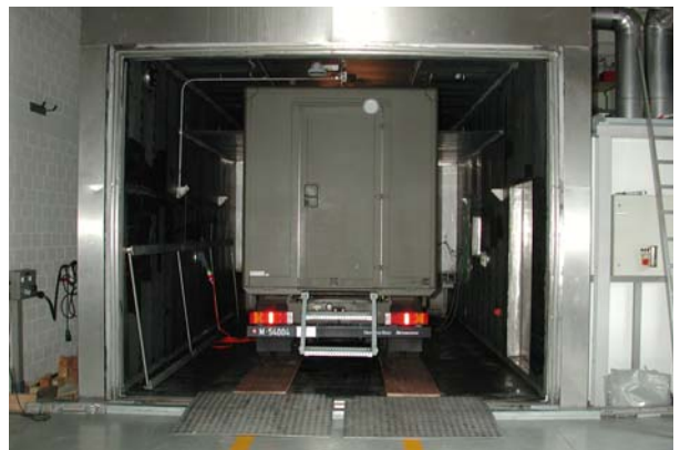
Das Verhalten einer Kunststoffkabine auf einem Bucher Duro wird durch die armasuisse geprüft.
