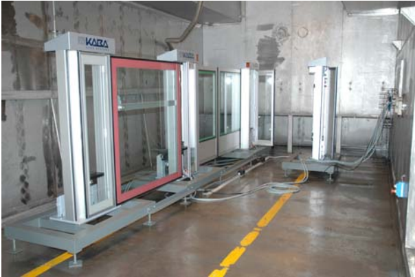
Die Schiebetore werden bei Kälte und Wärme auf ihre Funktion getestet (Kaba Gilgen AG).
