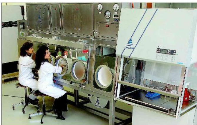
HANDSCHUHBOX Hier werden im Labor Spiez Briefe untersucht, welche die Polizei mit Anthrax-Verdacht ins Labor bringt. (s.az) z.az
