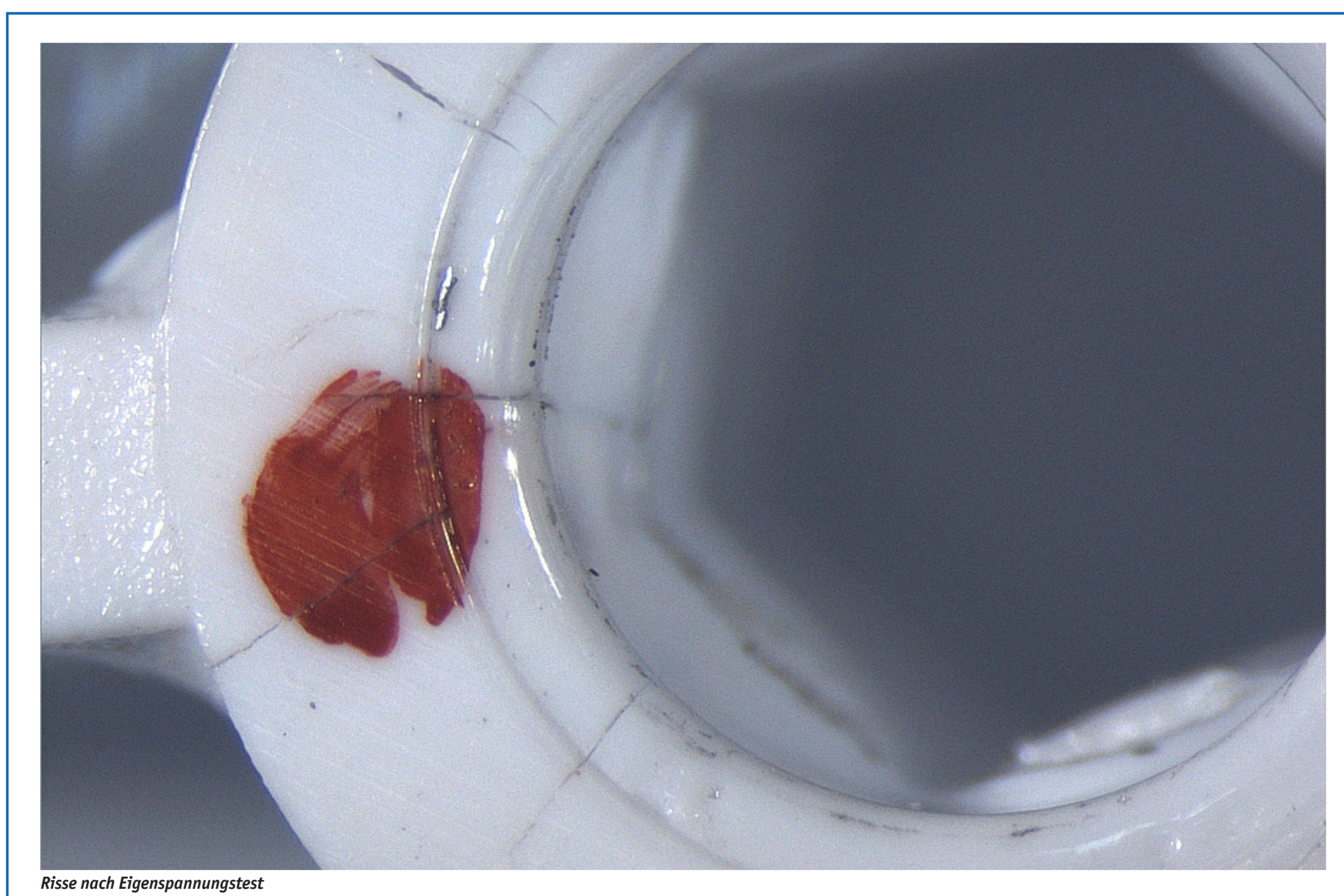
Risse nach Eigenspannungstest
