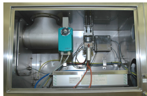
Zur Dekontamination der Anlage wird Wasserstoffperoxid auf eine Heizplatte dosiert, verdampft und durch einen Ventilator in der Anlage verteilt.
