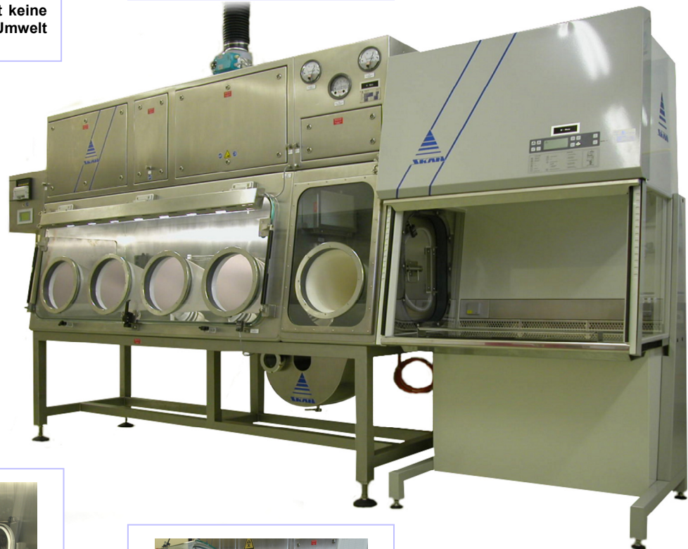
Zur Dekontamination der Anlage wird Wasserstoffperoxid auf eine Heizplatte dosiert, verdampft und durch einen Ventilator in der Anlage verteilt.
