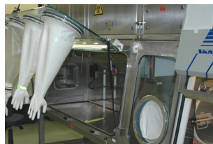
Ist die Anlage dekontaminiert, kann die Frontscheibe geöffnet werden.
