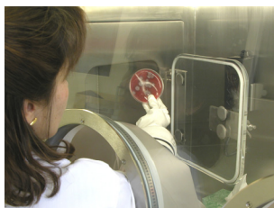
Der angedockte Inkubator kann über den äussersten Handschuh bedient werden.
