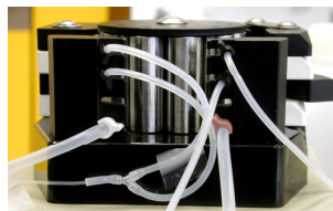
Abbildung 4 Dosierung des internen Standards: Als interner Standard wurden 115 In, 72 Ge und 159 Tb verwendet. Die interne Standardlösung enthielt im weiteren: Ca, Mg, Na, K, Fe. Die Matrix war 100-fach verdünnter LRB in Salpetersäure 2%. Die interne Standardlösung wurde on-line zudosiert.
