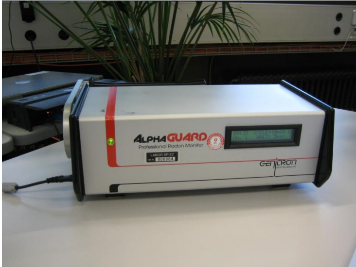
Bild 3: AlphaGUARD (mobiles Radonmessgerät)
