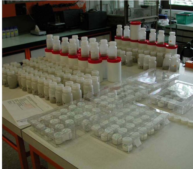
Vorbereitete, gemahlene Bodenproben für die Analytik
