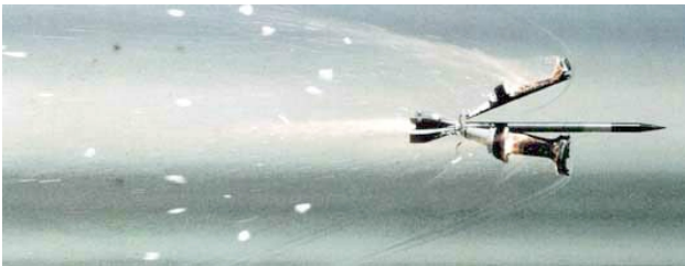
Figure 1: Le projectile-flèche peu après le tir, au moment où la flèche se sépare du sabot
