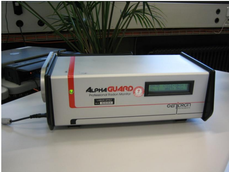
Figure 3: AlphaGUARD (appareil mobile de mesure du radon)
