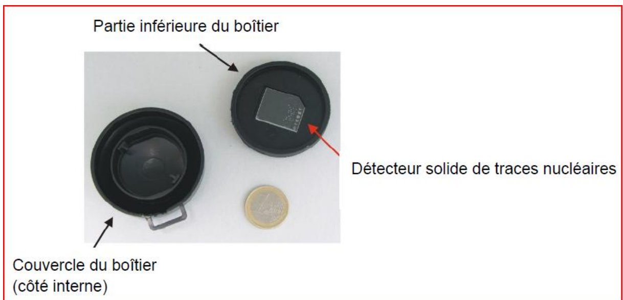
Figure 4: Détecteur solide de traces nucléaires
